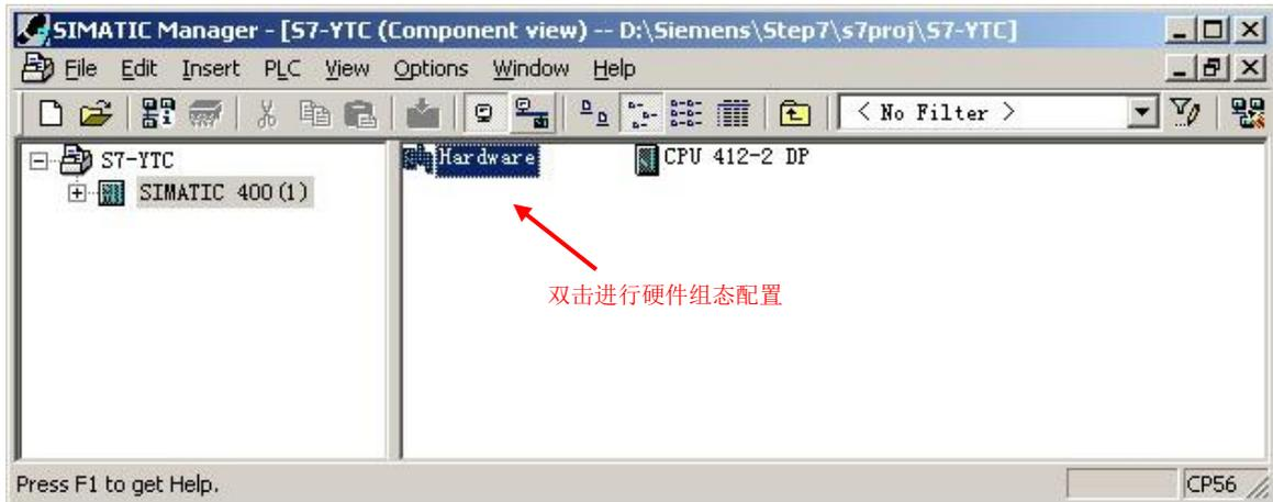
图 5.4 选择 PLC 主站，新建工程
